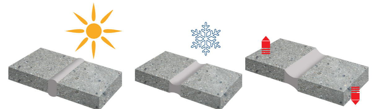
Zgjerim i elementeve të konstruksionit (bymimi i fugës)
